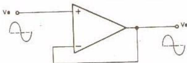
É um amplificador não inverter com ganho unitário e seu uso é idêntico ao transistor como seguidor de emissor, separando o sinal de entrada da carga. Zin é alta e Zout é baixa.  $A_v = 1$
